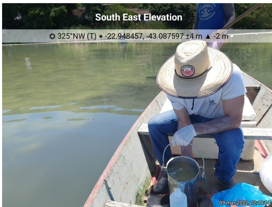
Figura 12: Transferência do material coletado através do coletor para os frascos.
