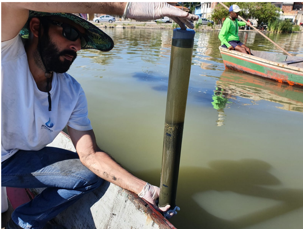
Figura 16: Coleta de material sedimentar com amostrador vertical na lagoa de Piratininga.
