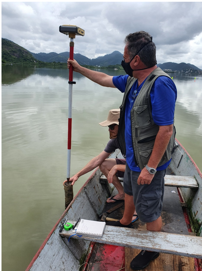
Figura 22: Aferição da altitude da camada de lodo na estaca no ponto de monitoramento em relação ao Marco.
