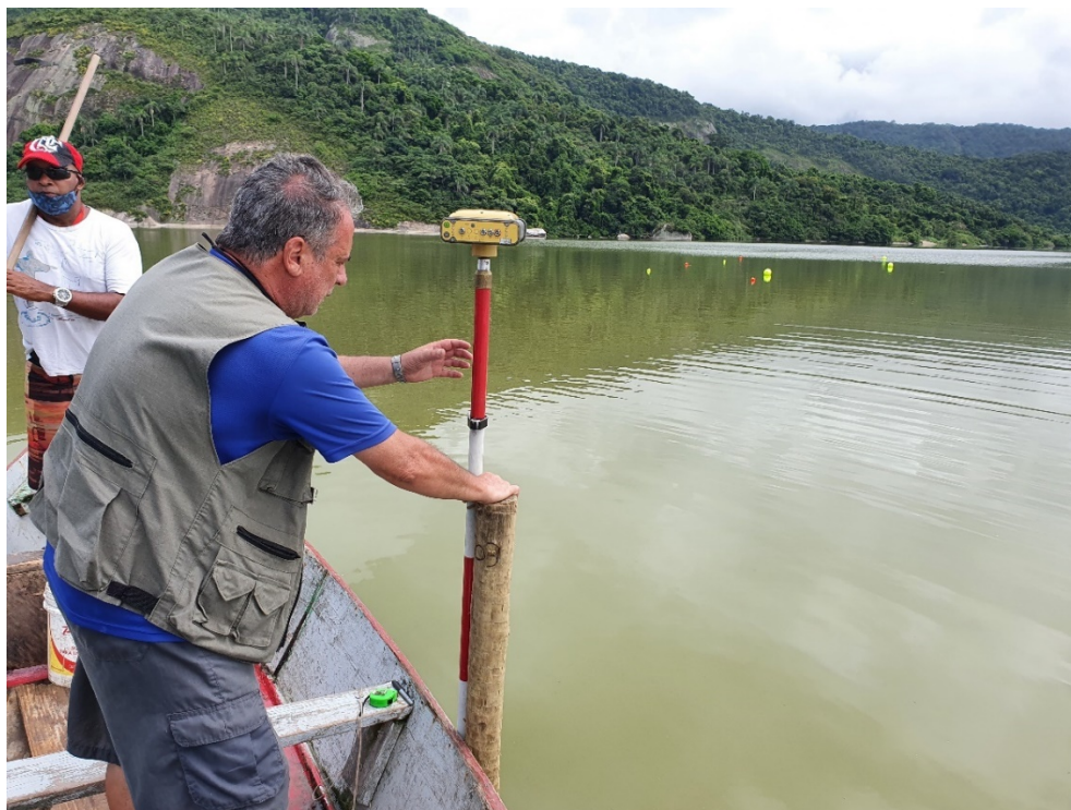
Figura 23: Aferição da altitude ortométrica do fundo lagunar com auxílio da estaca e da antena GNSS.
