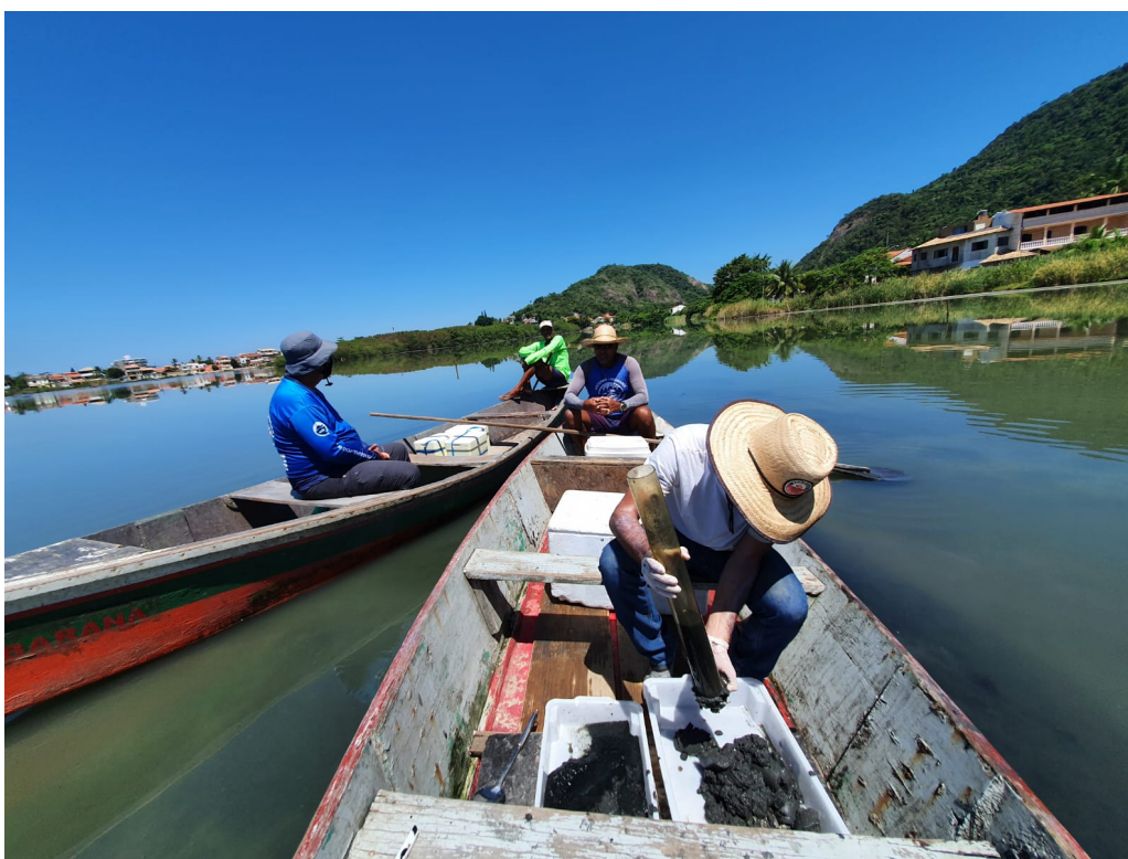
Figura 17: Depósito do material em bandeja para composição da amostra composta para as duas camadas, superficial e subsuperficial.
